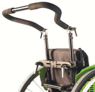
Педадь - высота, угол и ширина регулируются
